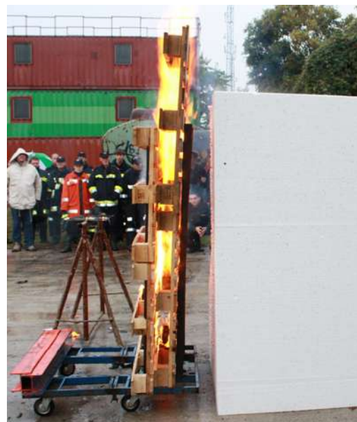
Imagen: Quema del pallet de madera enfrente del bloque para construcción de EPS
